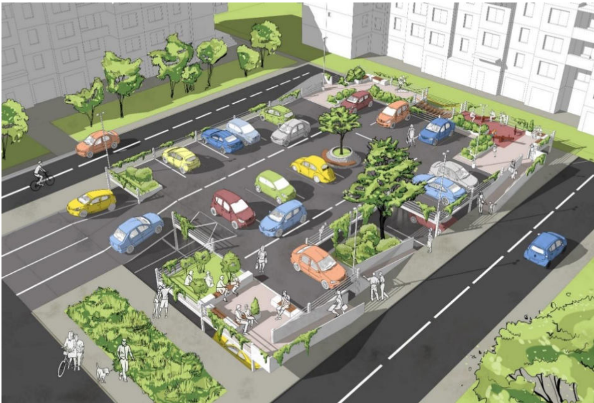
Figură 6-13 Mod de amenajare parcare 2 nivele cu nivelul superior axat pe locuri de parcare; Sursa: Portofoliu consultant
